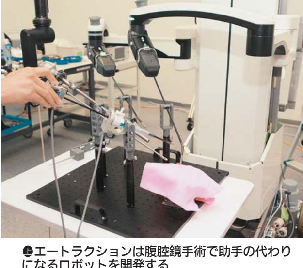
①エートラクションは腹腔鏡手術で助手の代わりになるロボットを開発する
