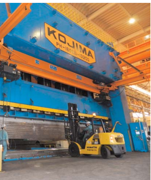
1万6000トプレス機で鋼管などを加工する
