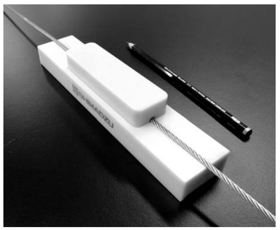
試作したワイヤロープ検査用 センサーモジュール
